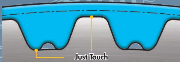
使用樁本時規皮帶時，齒尖與齒底會緊密接觸（Just Touch方式），實現無多邊形運動且可抑制旋轉不均的高精度傳動。此外，由於背隙極小，能保持高度的定位精度。
